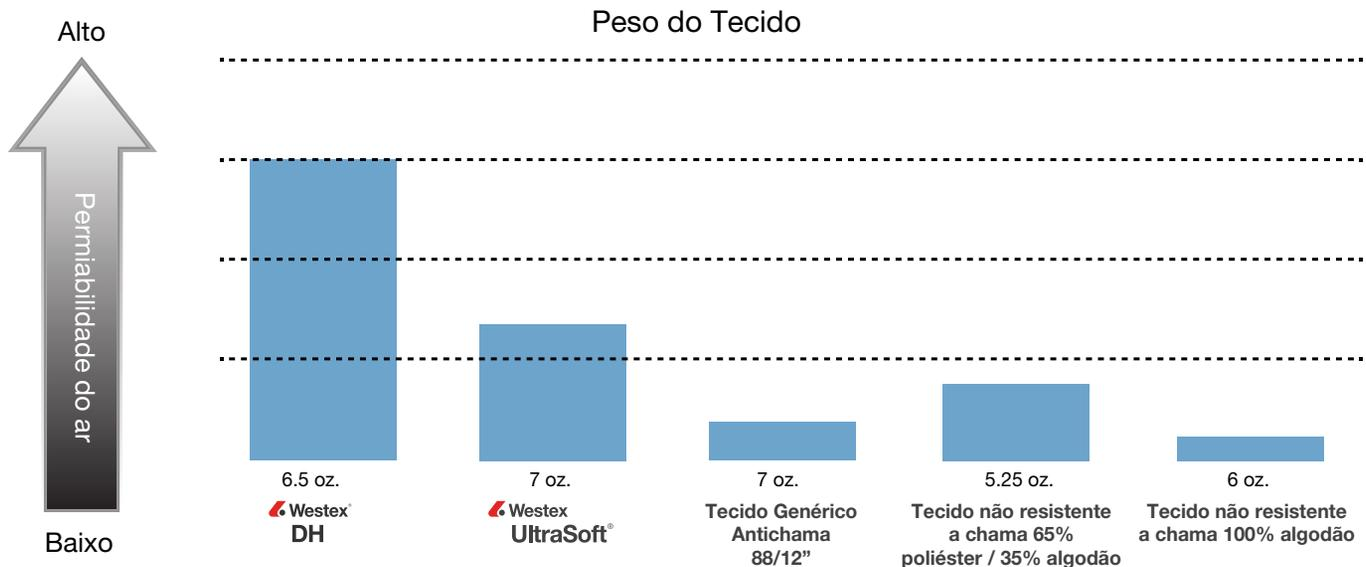
**Permeabilidade do ar** - A permeabilidade, ou a facilidade com que o ar passa através do material têxtil.
